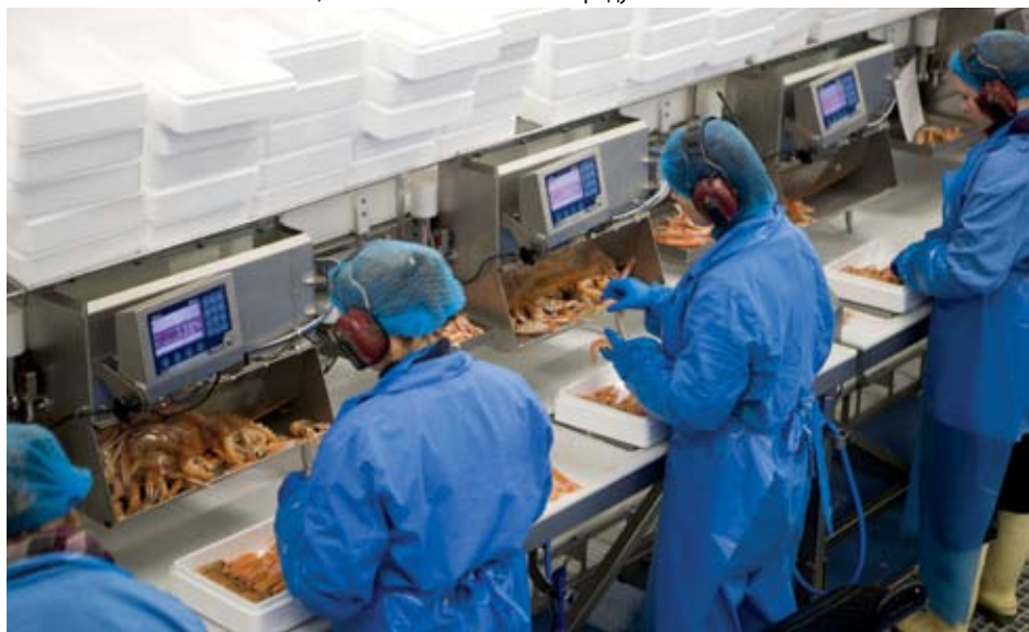
Каждые весы-грейдер Marel оснащены 24 эргономичными упаковочными установками под управлением интеллектуального программного обеспечения Marel Innova, обеспечивающего управление процессом и мониторинг.
