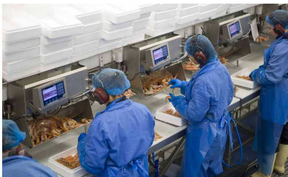
Jeder Marel-Gewichtssortierer ist mit insgesamt 24 ergonomisch gestalteten Packstationen ausgestattet und wird über die intelligente Produktionsmanagement- und -überwachungssoftware Innova von Marel gesteuert.
